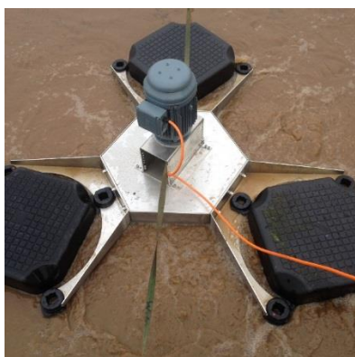
Figure 3. Turbine Hydro2 : vue du dessus avec les 3 modules de flotteurs.
