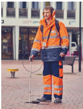
Corrélation acoustique et écoute électro-acoustique : **SeCorrPhon AC 200**
