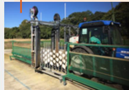
Test du pulvérisateur BLISS sur le banc de mesure EvaSprayViti au centre Irstea de Montpellier © Irstea
