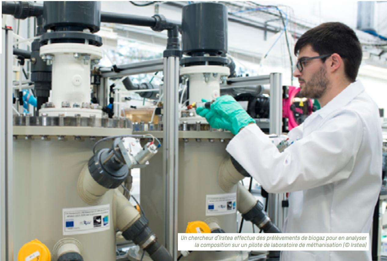
Un chercheur d'Irstea effectue des prélèvements de biogaz pour en analyser la composition sur un pilote de laboratoire de méthanisation (© Irstea)
