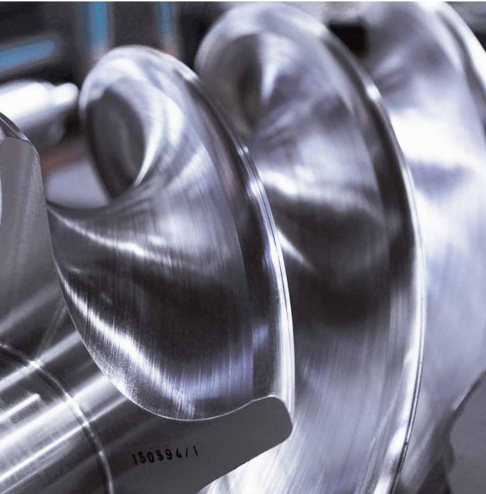
*Les profils de rotor sont caractéristiques des compresseurs à vis AERZEN, et garantissent des performances de fonctionnement nettement supérieures, tant en surpression qu'en dépression.*
