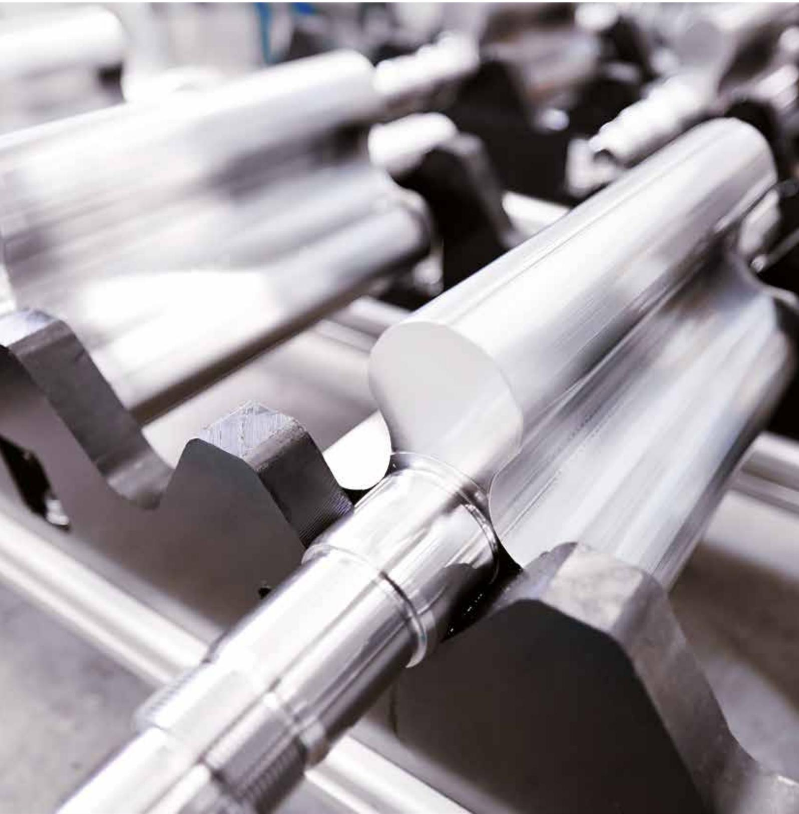
*Les surpresseurs à pistons rotatifs AERZEN sont des produits standardisés issus d'une recherche poussée. Fabriqués avec des machines à commandes numériques, ils sont conçus pour garantir des tolérances minimales entre les composants, ainsi qu'un haut niveau de performance. Made by AERZEN.*
