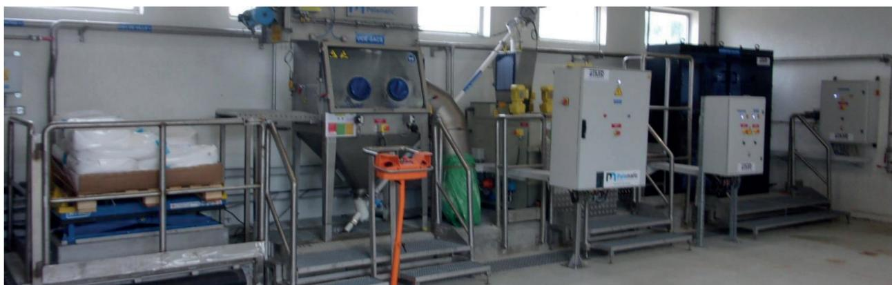
Chaîne automatisée complète de préparation et de distribution de floculant en poudre
