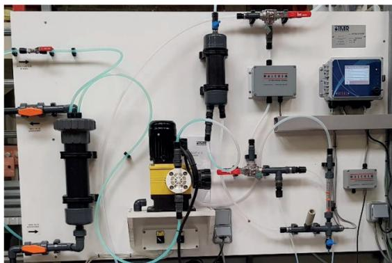
Platine d'analyse d'un bain de nickel
