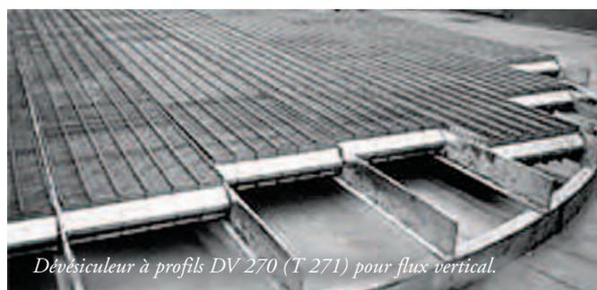
*Dévésiculateur à profils DV 270 (T 271) pour flux vertical.*
