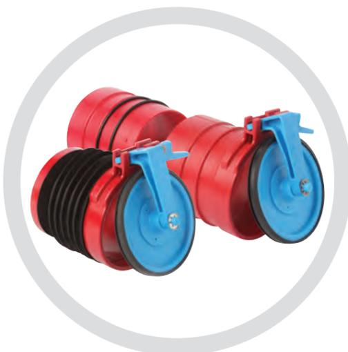
Ferco, propose aussi une gamme de clapets en ligne verrouillables (série 5000), du DN 50 au DN 315, corps ABS et abattant simple inox, conformes à la norme EN 13564
