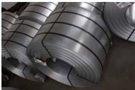
La masse de zinc déposée est au moins de 725 g/m<sup>2</sup> (Z725), pour une garantie de 640 g/m<sup>2</sup> en tout point.
