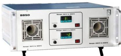
1 modèle **DUO**: Le calibrateur de température portable **CN-DT** combine deux sources de corps noir basse & moyenne températures. Il couvre les 2 plages de température suivantes avec une très grande précision. Il permet simultanément la mesure de deux pyromètres.
