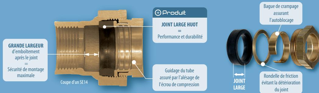
concept REXUO avec JOINT LARGE = **SÉCURITÉ DE POSE**
