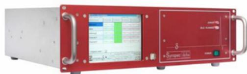
Combiné à un sélecteur multivoies, cet instrument effectue des prélèvements dans les zones sensibles de votre site afin d'analyser les concentrations d'hydrocarbures présentes dans l'air.
