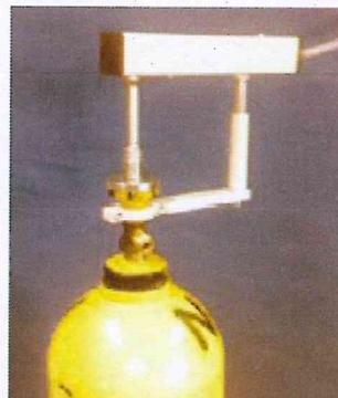
Il permet la fermeture automatique des bouteilles de chlore en cas de détection de fuite de chlore.
