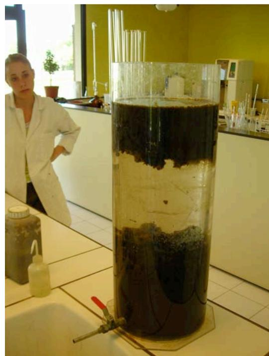
Il se produit après 2,5h de décantation, ne dure que quelques minutes et provoque de profonds changements dans la teneur de l'effluent en nitrates, phosphates, MES.
