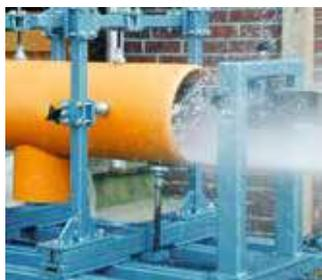
Fig. 3-24 Curage possible jusqu'à 340 bar
