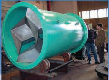
Mélangeurs statiques DN15 à DN3000 en tuyauteries ou canaux ouverts
